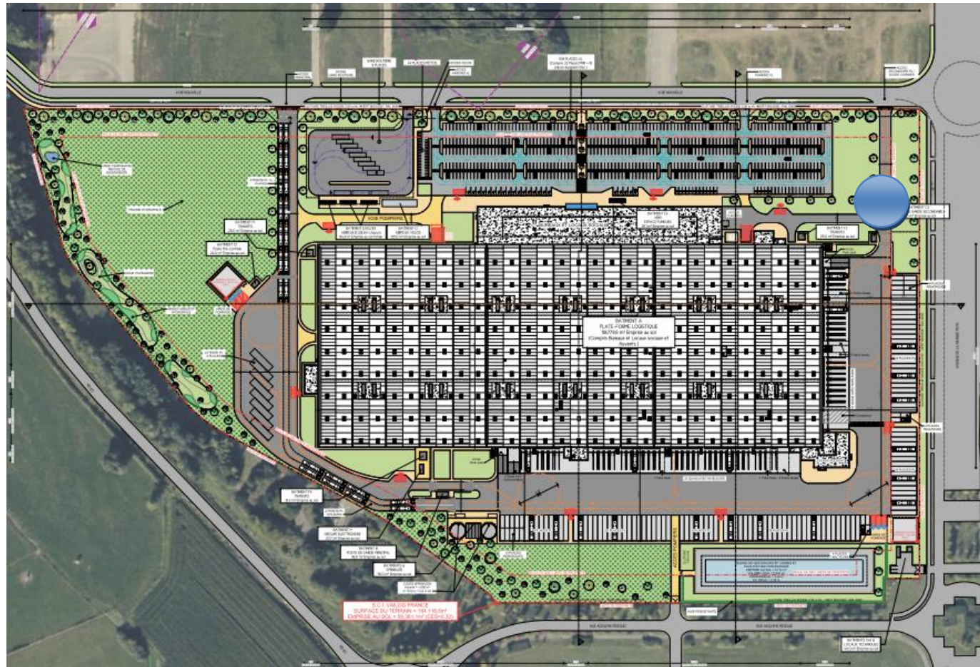
Figure 8 : Point bas correspondant à la zone de débordement attendu en cas de pluie centennale (Source : SODEREF)
